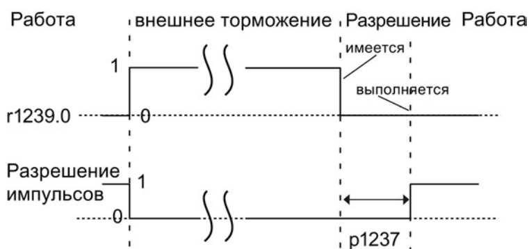
Изображение 7-3 Разрешение импульсов - характеристика сигнала короткого замыкания якоря без квитирования контактора
